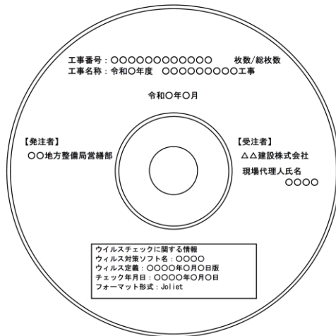
図：電子媒体への表記（工事例）
