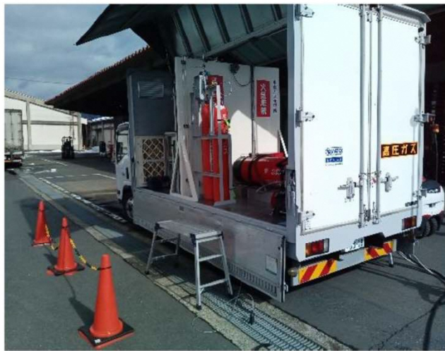
ドーターサイトでの充填作業写真 (三菱車の場合)
