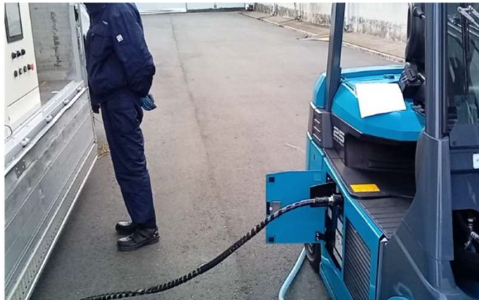
動画 ドーターサイト (移動式水素ステーション充填開始及び作業スペース)
