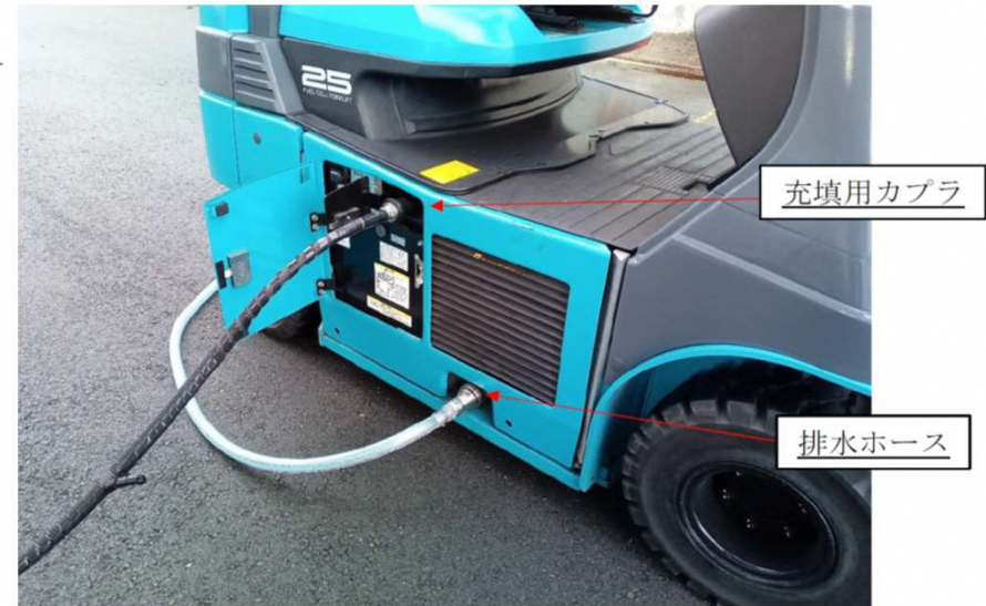
ドーターサイトでの作業写真 (トヨタ車の場合)
