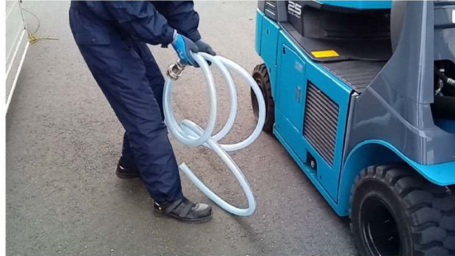
動画 ドーターサイト (移動式水素ステーション充填前 排水ホース接続)
