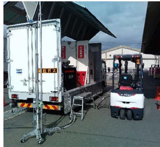
ドーターサイトでの充填作業写真 (三菱車の場合)
