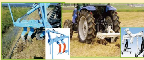
排水改良等の作業機(補助暗きょ)の導入 (写真左はカットドレーン、写真右はサブソイラ)※
