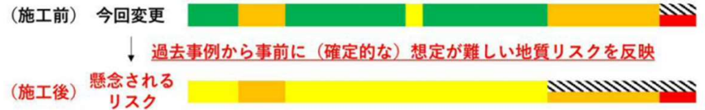
【図-12 <参考>懸念されるリスクを反映した支保構造の変更】
