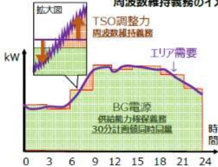
【現在（H28.4～）の供給能力確保義務、周波数維持義務のイメージ】
