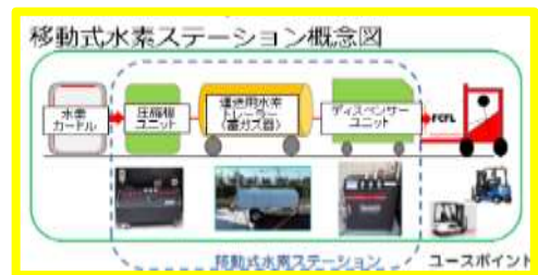
図 3-1-15 移動式水素ステーション概念図
