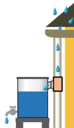
雨水貯留施設の仕組み
