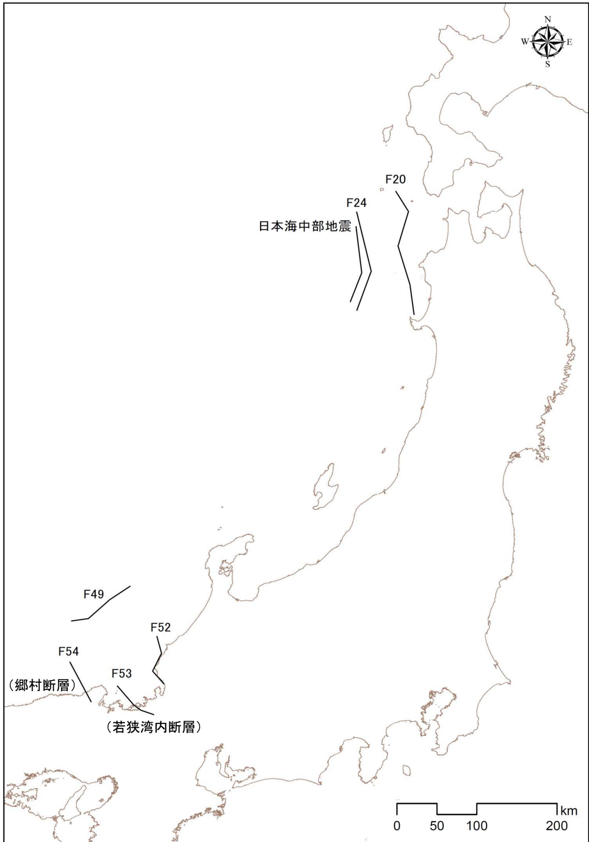
図2 被害想定の対象地震の断層位置
