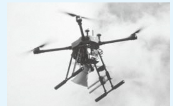
猟犬の声を鳴らしながら飛行するハンティングドローン
