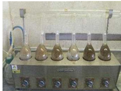
掘り出した肥料の全窒素分析（ケルダール法）
