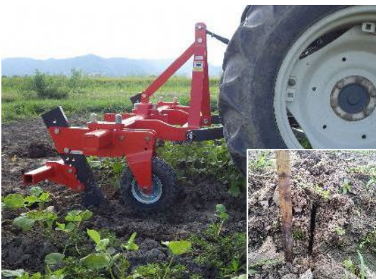
トラクターで畦間サブソイラを牽引している様子 (右下は牽引跡を横から見た図)
