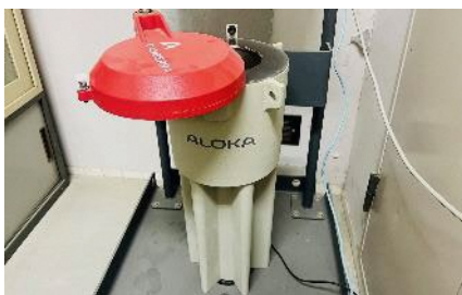
「NaI(Tl)」シンチレーション検出器による放射性物質の検査
