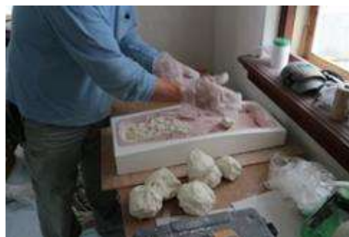
樹脂を流して型を作り漆喰を詰める工程
