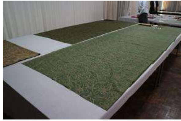
飾りカーテン生地を試作は少しずつ糸の色を変えて行い、10パターン以上に及んだ。
