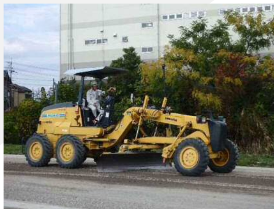
ICT建設機械施工 (3次元MCEータグレーダ)
