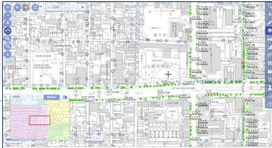
GISのパソコン画面 (表示例：市街灯・街路樹)
