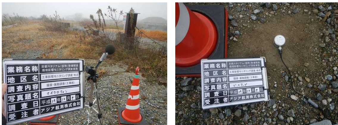
写真 2-1-2 騒音計マイクロフォン、振動計ピックアップの設置状況
