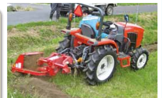
▲リターンデッチャで掘られた溝
